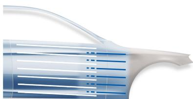
Aplicar 1 mano de Standoblue Basecoat hasta el borde de Standoblue Color blend y degradar el color. Aplique una mano de efecto desde la zona de difuminado fundiendo con la capa húmeda de color Standoblue
