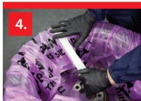
4. Drehen Sie das Rad vorsichtig um, so dass es zum Boden zeigt, ziehen Sie die Enden des Produktes zusammen und fixieren diese mit Klebeband.
