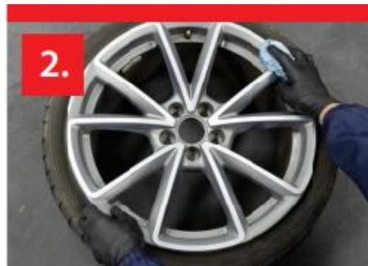
2. Reinigen Sie die Felge und stellen Sie sicher, dass sie frei von Schmutz und Fett ist.
