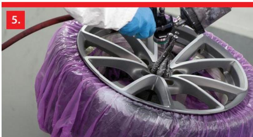
5. Drehen Sie das Rad um und überprüfen Sie, ob das elastische Band noch eine durchgängige Abdichtung bildet bevor Sie mit der Lackierung beginnen.
