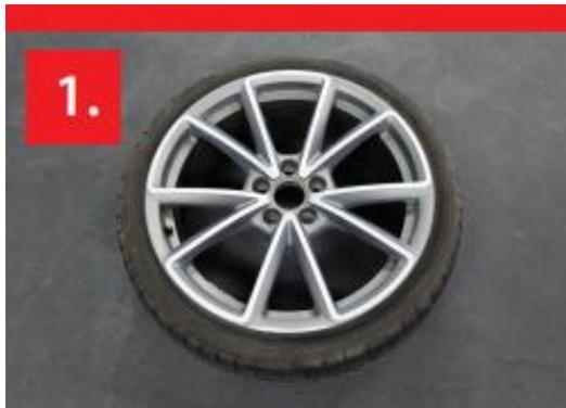
1. Entfernen Sie das Rad vom Fahrzeug und lassen Sie die Luft aus dem Reifen ab.
