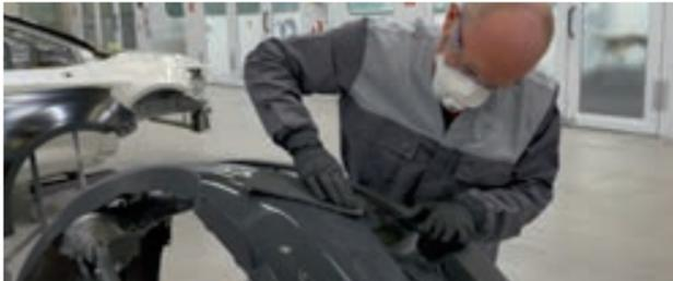
**SCHRITT 2:** Zur Vorreinigung ein mit **3871S Kunststoff-Reiniger** getränktes **Audurra Vlies Pad** grau benutzen.
