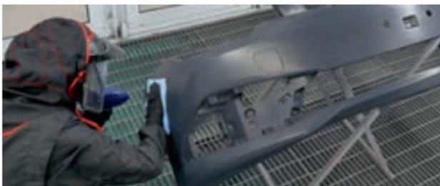
**SCHRITT 4:** Oberfläche mit Staubbindetuch reinigen und anschließend mit der **Stat-Gun** abblasen, um die statische Aufladung zu minimieren.
