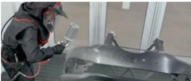
**SCHRITT 5:** **800R Kunststoffhaftvermittler** auftragen. Nach dem Ablüften **NS208x Ultra Performance Nass-in-Nass Füller** elastifiziert mit **AZ9405 Elastic Additiv** lackieren. Ablüften.
