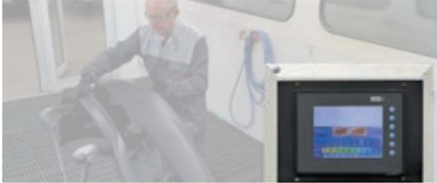
**SCHRITT 1:** Neue, gängige Kunststoffteile im Außenbereich von Fahrzeugen. 60 Min./60-65°C tempeln. Je nach Hitzebeständigkeit des Kunststoff- oder der Kunststoffmischung sollten einzelne Anbauteile entsprechend unterstützt werden, um eine Verformung zu vermeiden.
