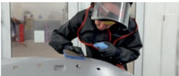
**SCHRITT 6:** Entfernen Sie bei Bedarf Staubeinschlüsse mit dem **Audurra Schleifschwamm Flex Blue**.
