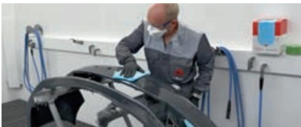
**SCHRITT 3:** Zur Nachreinigung ein mit **3950S Antistatischer Kunststoffreiniger** angefeuchtetes Tuch verwenden. Oberfläche abwischen, um Verunreinigungen zu lösen und zu entfernen. Sofort gründlich mit einem sauberen Tuch abwischen. Keine verschmutzten Tücher verwenden. Sämtliche Rückstände von Trennmitteln gründlich entfernen!
