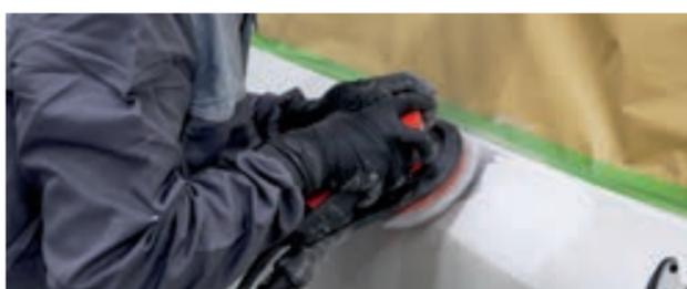
**SCHRITT 5:** Schleifen Sie die Übergangsbereiche der Reparaturzone mit **Audurra Premium Scheibe C**. Schleifen Sie die umliegenden Bereiche mit **Audurra Premium Schleifscheibe D**.
