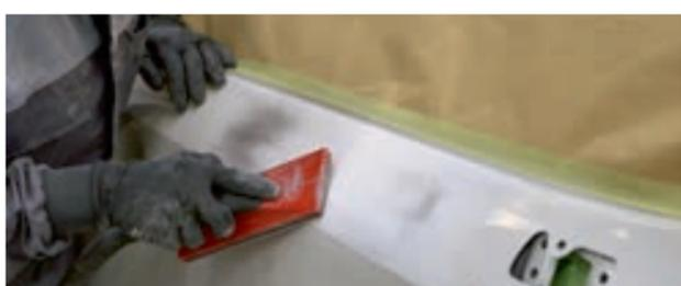
**SCHRITT 7:** **Audurra Kontrollpulver** auftragen, anschließend den Reparaturbereich mit **Handblock** mit **Audurra Premium Schleifstreifen C** schleifen.
