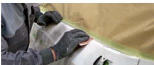
**SCHRITT 8:** Ecken und Kanten mit **Audurra Soft Rolle E** von Hand schleifen. Die restliche Oberfläche mit dem Exzentrerschleifer und **Audurra Premium Schleifscheiben D** schleifen. Schleifstaub entfernen und vor dem Abdecken reinigen.
