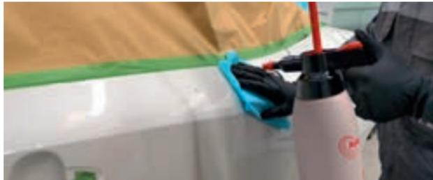
**SCHRITT 1:** Reinigen und prüfen Sie die beschädigte Stelle. Verwenden Sie hierfür **3919S Prepsol** und das **Audurra Entfettungstuch**.
