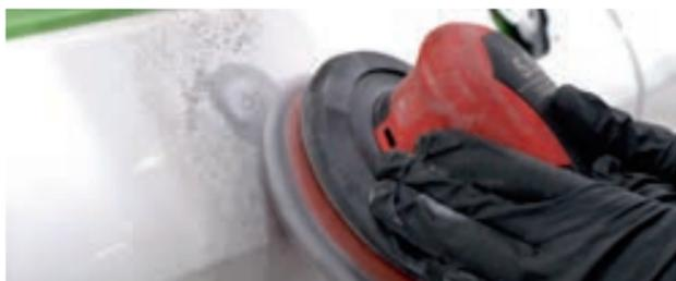
**SCHRITT 2:** Mit **Audurra Premium Schleifscheibe B/C** schleifen, um den vorhandenen Lack zu entfernen. Wenn Spachtel aufgetragen werden muss, den Bereich mit der **Audurra Premium Schleifscheibe B** schleifen.
