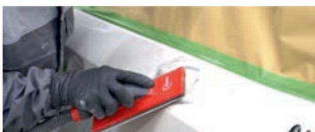
**SCHRITT 4:** Spachtel mit **Handblock** und **Audurra Premium Schleifstreifen B** und anschließend mit **Audurra Premium Streifen C** schleifen. Verwenden Sie **Audurra Kontrollpulver** während aller Schleifschritte.
