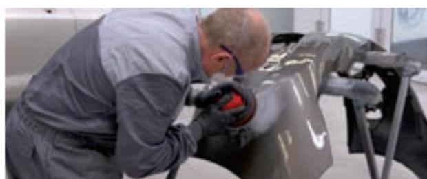
**SCHRITT 2:** Mit **Audurra Premium Schleifscheibe B/C** Beschädigungen ausschleifen.
