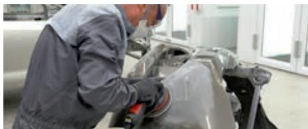
**SCHRITT 5:** Schleifen Sie die Übergangsbereiche der Reparaturzone mit **Audurra Premium Schleifscheibe C/D** aus. Zum Schleifen der Ecken und Kanten verwenden Sie den **Audurra Schleifschwamm Grün** oder **Soft Rolle D**.
