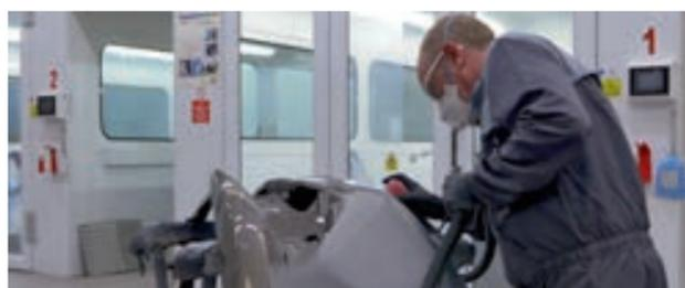
**SCHRITT 7:** Ecken und Kanten von Hand mit **Audurra Schleifschwamm Flex blau** schleifen. Maschinenschliff mit **Audurra Premium Schleifscheiben D** und geeigneter **Audurra Schaumstoff-Zwischenscheibe**. Schleifstaub entfernen und reinigen.
