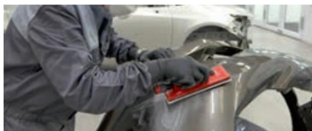
**SCHRITT 4:** Mit **Audurra Premium Schleifstreifen B** in Form schleifen. Nachschleifen der Reparaturzone mit Körnung C
