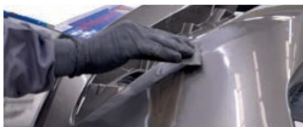
**SCHRITT 3:** Für tiefe Schäden **PP0481 Kunststoff-Spachtel** auftragen. Optional: Vor dem Spachtel **800RA Kunststoff- Haftvermittler** auftragen.
