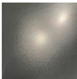
Alesta® SD s matným povrchem 30GU po testu Martindale
