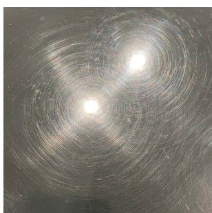
Citlivý tmavý lesklý povrch 80GU po testu Martindale
