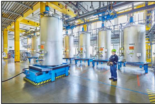
In unserer Wasserlack-Fabrik im Werk 2 werden die Mischbehälter mit schwerem Gerät bewegt
